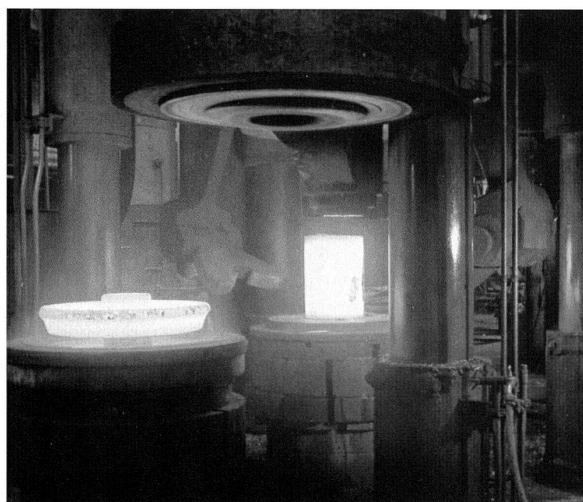
Pressen eines Radsatzes auf der Loch- und Stauchpresse der Henrichshütte, 1950er-Jahre (Bildnachweis: privat).
