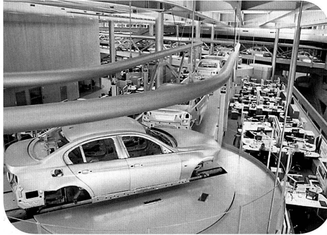
Förderstrecken im Zentralgebäude.
