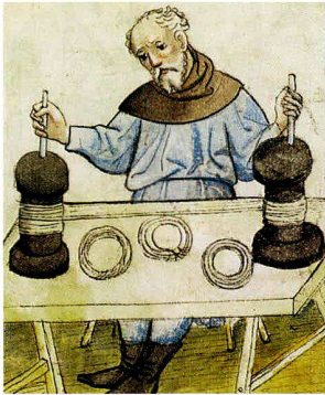
Bild 2: Mendelsches Hausbuch: Drahtzieher im Windenverfahren, 1425/26; Zieheisen und Kurbeln fehlen. (Quelle: Stadtbibliothek Nürnberg, Amb. 317,2°)
