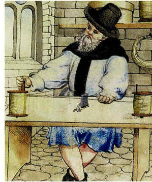
Bild 3: Mendelsches Hausbuch: Drahtzieher im Windenverfahren, 1529. (Quelle: Stadtbibliothek Nürnberg, Amb. 317,2°)
