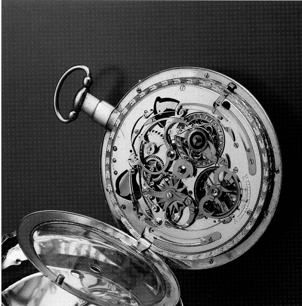
Bild 24: Vollendete Uhrmacherarbeit: Taschenuhr mit Viertelstundenrepetition, Du Bois, Le Loncle, Anfang 19. Jahrhundert. (Foto: MIH)
