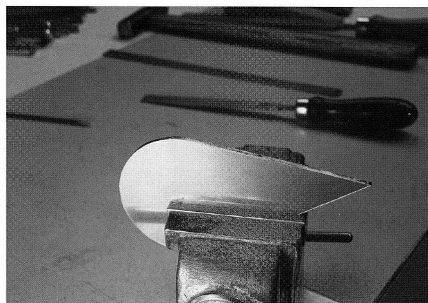
Bild 15: Nachgefeiltes Teil. (Foto: L. Oechslin)
