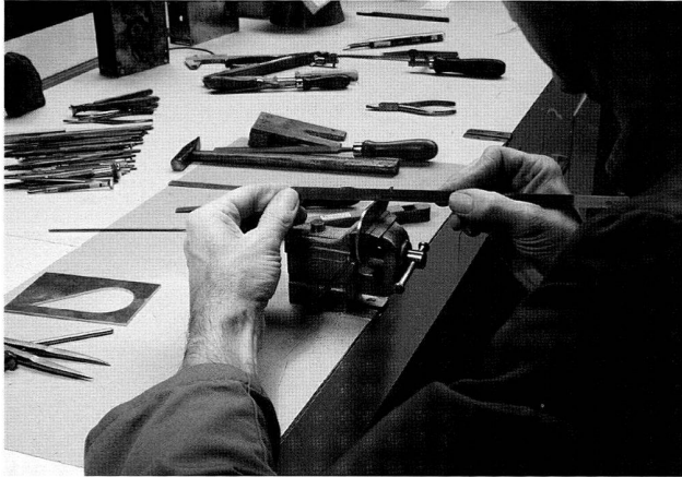
Bild 22: Nachbearbeitung mit der Schmirgellatte. (Foto: L. Oechslin)
