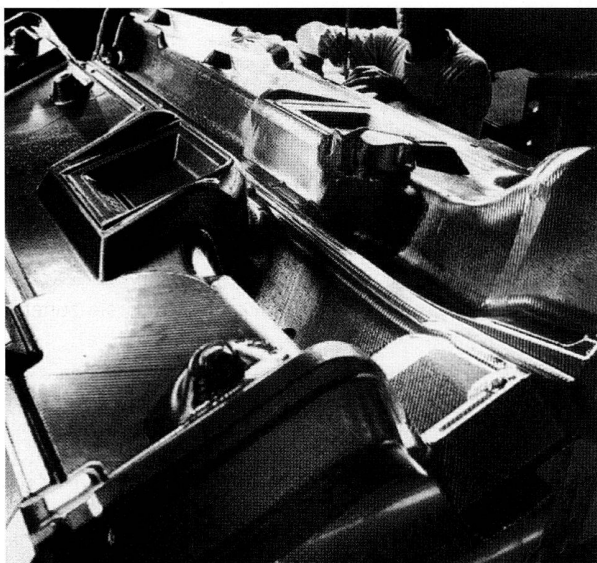
Bild 13 und 14: Herstellung von grossformatigen Werkzeugen aus Kunststoffformenstahl für den Kunststoff-Spritzguss. (Fotos: Slanina, N., 150 Jahre Stahl in Witten, Unna 2004)
