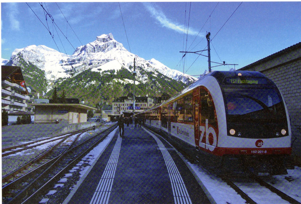
Neuer Triebzug der Zentralbahn in Engelberg. Im siebenteiligen Zug sind vier Triebzahnräder und acht Adhäsionstriebzahnradsätze vorhanden.
