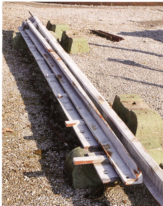
Ab 1902 setzten die SBB auf die materialintensiven und robusten Weichen mit durchgehenden Untertagsblechen, die auch in Deutschland und in Mitteleuropa eingesetzt wurden.
