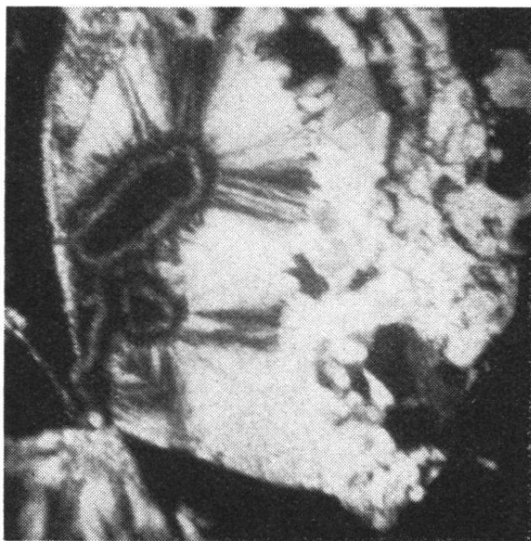
Fig. 13. Quartz sphérolitique dans un calcaire marneux (gross. 30 x, lumière polarisée), p. 89
