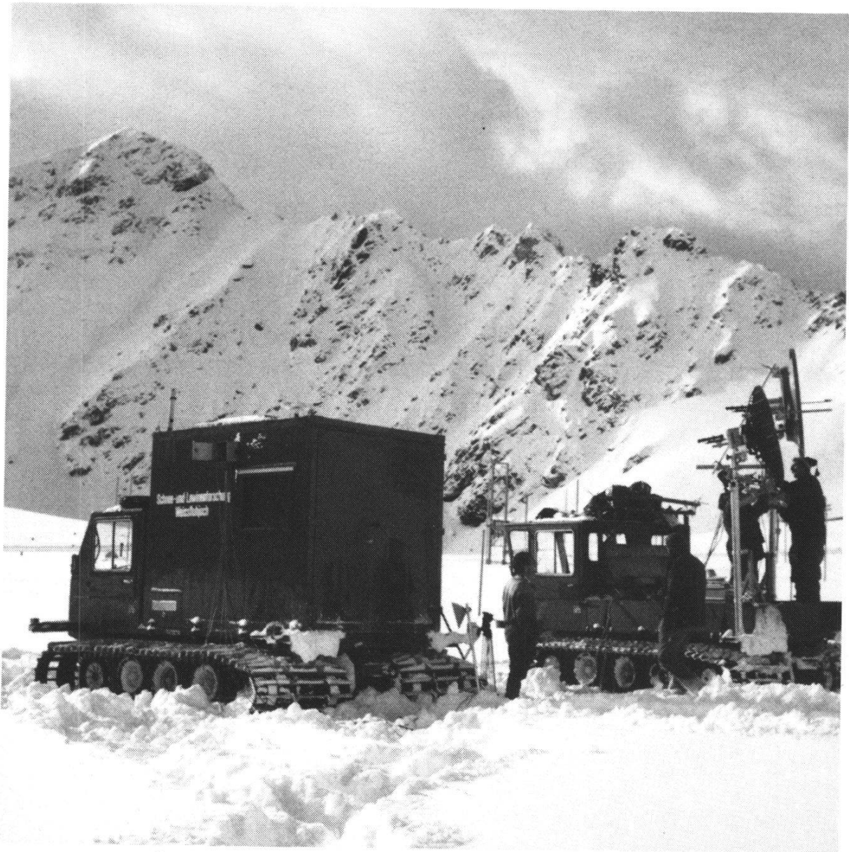
Fig. 1: Auf Überschneefahrzeugen montierte Dopplerradarsysteme zur Messung von Fließlawinengeschwindigkeiten.
