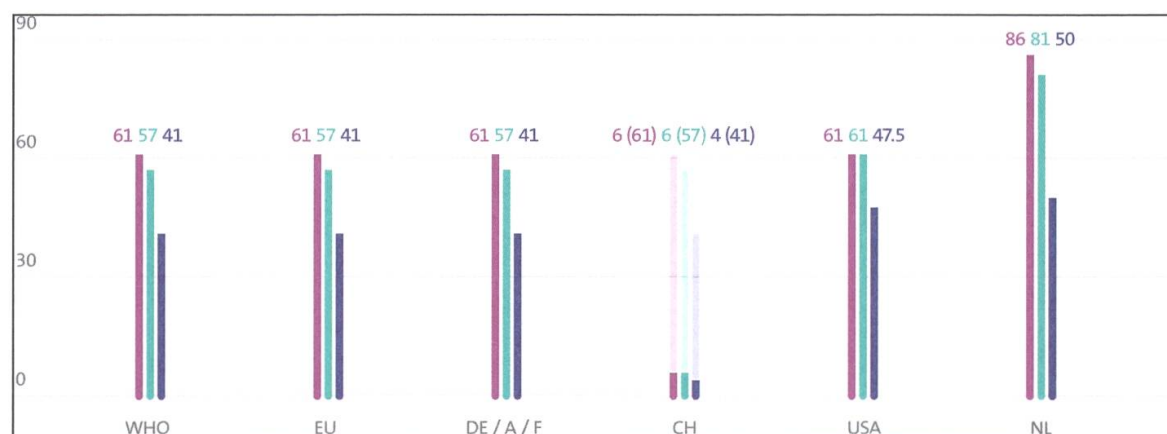
Fig. 3 : Réglementation des immission pour les champs électromagnétiques produit par la téléphonie mobile dans différents pays en V/m. Ces valeurs se basent sur les recommandations de l'ICNIRP, que la plupart des pays – y compris l'OMS, mais sans les Pays Bas – appliquent sans modification. Les valeurs pour le champ électrique sont données en volts par mètre. Légende : ■ pour 2100 MHz ou plus ; ■ pour 1800 MHz ; ■ pour 900 MHz. Pour la Suisse l'ORNI fixe à la fois des limites d'immissions (couleurs claires) et des valeurs d'installation (en couleurs foncées) . Les dernières sont dix fois plus basses et sont valables pour les lieux à utilisation sensible tels que bureaux, logements, écoles, hôpitaux et homes, etc. La Suisse se base ici sur le principe de précaution, comme il est évoqué dans la LPE. 8
