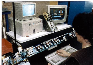
Der Korrekturtisch. Eine Videokamera liest die Bildrückseite
