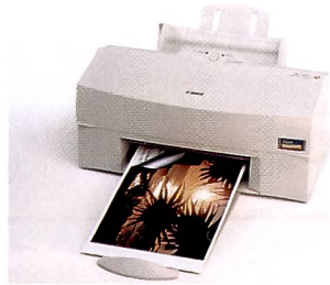
Beim Canon BJC-7000 reichte in unserem Test die Tinte am längsten: 94 A4-Ausdrücke!
