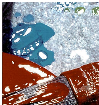
Ausschnittsvergrösserung von Lightjet- (l.) und Inkjet-Ausdruck (r.) im Vergleich: Bei gleicher Datenmenge liefert der Lightjet homogenere Flächen, feinere Modulationen und schärfere Kanten.
