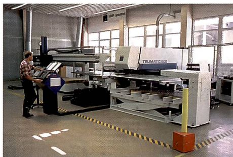
Für die Bearbeitung der grossen Gehäuseteile sind teure, computergesteuerte Maschinen mit langen Vorschubwegen erforderlich.
