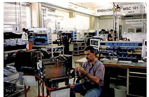
Die Montage der Scannereinheiten für MSC- und MSP-Geräte verlangt viel manuelles Geschick und höchste Konzentration.
