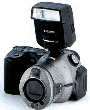
Der Bildsensor der auf der CeBIT '98 erstmals präsentierten Canon PowerShot Pro 70 weist 1536 x 1024 Pixel auf.
