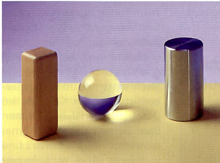
Überprüfen Sie Ihre Beleuchtungseinrichtung an einfachen Objekten mit Material und Oberfläche, wie sie in Ihrer Arbeit vorkommen. Platzieren Sie die Leuchten auf Normalentfernung, lassen sie jedoch alle einzeln aus derselben Richtung einwirken. Vergleichen Sie die Wirkung von 1. Softlicht, 2. Flutlicht und 3. Spotlicht. Wenn die Schatten stimmen, sorgen die Lichter für sich selbst.
