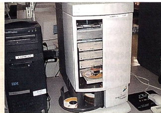
Automatische Schreibstation, bestehend aus vier CD-Brennern und einer Beschriftungseinheit.
