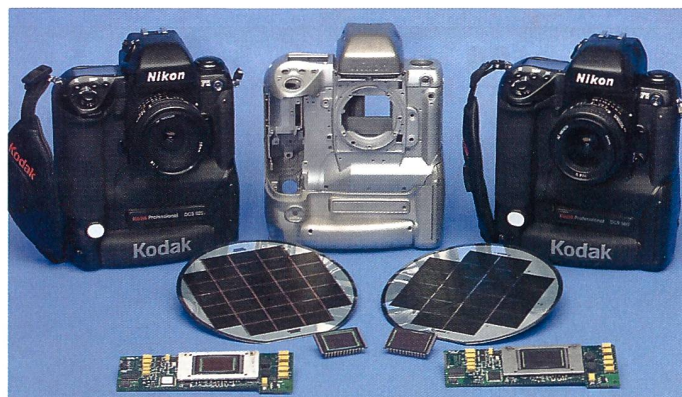
Kameratechnische Basis der neuen Kodak DCS 620x ist die profibewährte Nikon F5 mit ihrem Leichtmetallgehäuse. Im Vordergrund sind zwei Wafer, zwei CCD-Sensoren und zwei DCS-Bords zu sehen.
