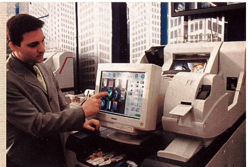
Das Gretag Master Lab Digital ist mit nur 1,3 m 2 Standfläche das kompakteste Minilab der Leistungsklasse von 1000 Bilder pro Stunde. Es wird komfortabel über einen Touchscreen bedient.
