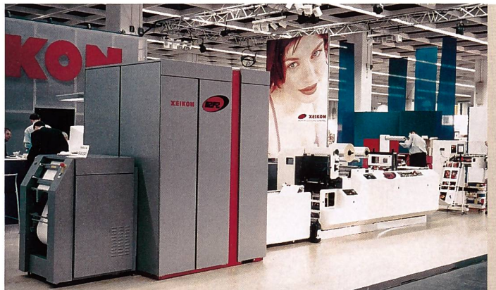
Alternative zum heutigen Nassverfahren sind Anlagen, die nach dem elektrostatischen Tonerprinzip arbeiten, wie Indigo und Xeikon (Bild).
