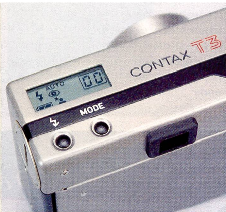
Die Tasten für die Wahl der Blitz- und Individualfunktionen sowie die Modetaste.
