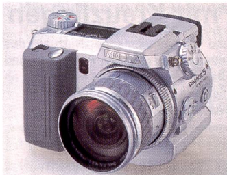
Die preisgünstigere Dimage 5 besitzt einen 3,3 Mpix Chip und ein 7x Zoom, das auf die extreme Weitwinkelposition von 28 mm (entsp. KB) verzichtet und dafür bis 250 mm reicht.
