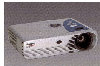
Der Liesegang ddv 911 ist mit einer dvi-Schnittstelle ausgestattet und leistet 1400 ANSI-Lumen und erlaubt eine Keystone-Korrektur von 40°. Auflösung: XGA.
