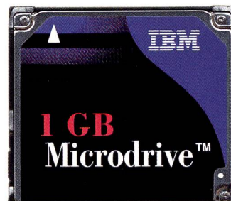
Der IBM Microdrive ist eine Miniatur-Festplatte, mit demnächst bis zu zwei Gigabyte Speicherkapazität. Sie ist kompatibel zum CompactFlash Standard.
