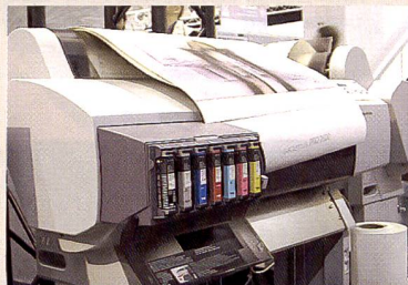
Epson Stylus Pro 7600 zeigt den Einsatz der UltraChrome-Tinten mit sieben Farben in der Praxis.
