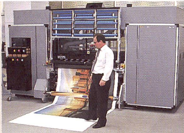
Durst Hochleistungs-Ink-Jet-Drucker Rho 160 druckt auf einer Breite bis 158 cm und ca. 45 m 2 pro Stunde.
