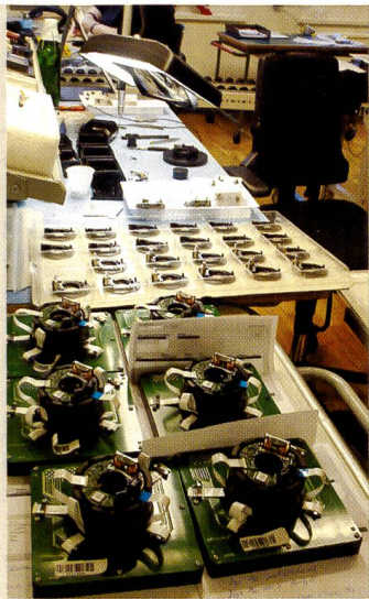
Der Zentralverschluss wird auf einer Platine montiert...
