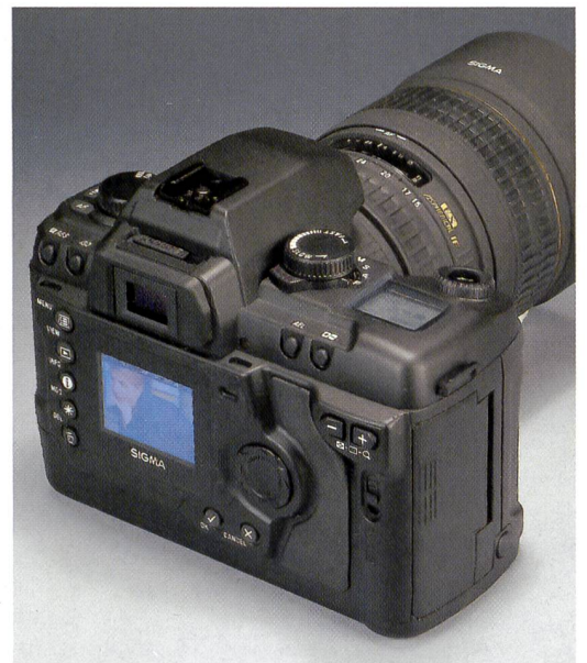
Die Sigma SD9 wirkt etwas bullig, ist aber handlich. Die Bedienelemente sind übersichtlich angeordnet und orientieren sich an der analogen SA9. Der grosse Monitor zeigt auf Knopfdruck die wichtigsten Bildinformationen.
