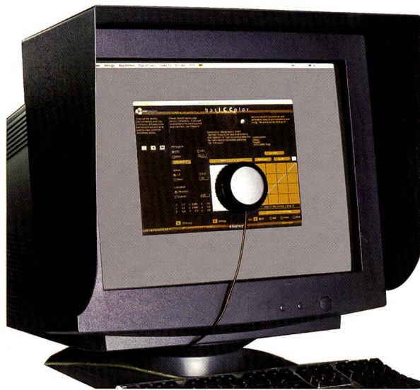
Kalibration und Profilierung passen die Farbwiedergabe unterschiedlicher Monitore an, so weit dies der jeweilige Monitor-Farbraum zulässt.
