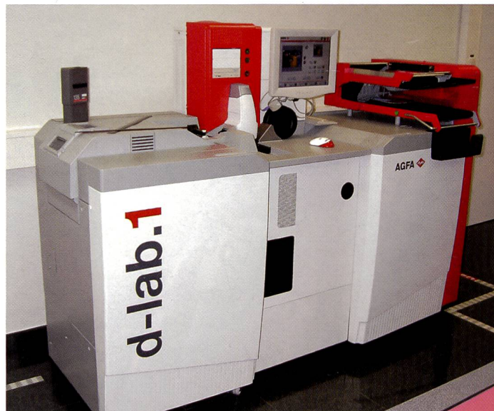
Das neue Agfa Minilab d-lab.1 benötigt wenig Standfläche und lässt sich von der Frontseite her mit Chemiepack und zwei Papiermagazinen bequem und übersichtlich bedienen.
