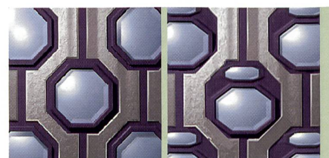
Die Pixelanordnung des Super-CCD der dritten Generation (links) und der neue Super-CCD-SR der vierten Generation (rechts).
