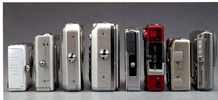
Die flache Konstruktion wird auf verschiedene Weise gelöst: Sehr kompakt nur mit Digitalzoom, mit einem ins Gehäuse integrierten Zoom resultiert mehr Bauhöhe oder -breite, und als weitere Varianten gibt es verdrehbare Gehäuse oder ausfahrbare Zooms mit Wegschieben von Linsengliedern.
