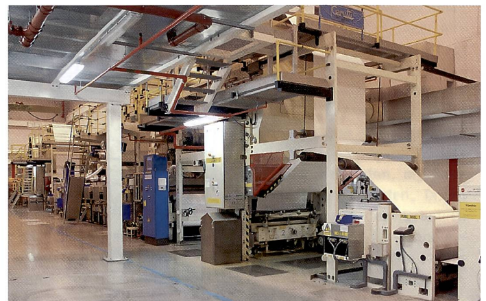
Die Herstellung von Fotopapier erfolgt in einem kontinuierlichen Prozess. Die riesigen Papierrollen werden beschichtet und konfektioniert. (Kodak Harrow)
