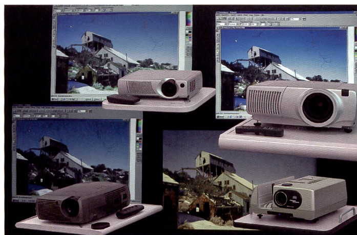
Die Versuchsanordnung bei der Firma Ott + Wyss in Zofingen: Der Diaprojektor Braun SC 668 (rechts unten) gegen drei Beamer unterschiedlicher Preiskategorien. Links unten das Home Cinéma Modell Geha Compact 107 plus (2195.- Franken), darüber das Business-Modell Liesegang dv 455 (3'655.- Franken), rechts oben das Top-Modell Liesegang dv 560 flex (10'995.- Franken). Deutlich erkennbar die wärmere Farbdarstellung des Diaprojektors und die tiefere Lichtstärke des Home Cinéma Beamers.
