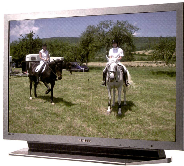
Plasmabildschirme eignen sich am besten für eine sehr grosse und sehr dünne Bauweise, allerdings hält sich die absolute Auflösung stets in einem etwas beschränkten Rahmen. (Bild: Samsung)
