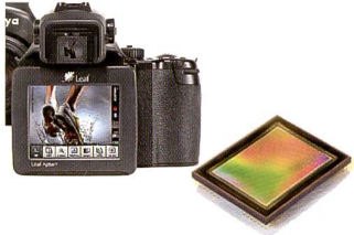
Das neue Leaf Aptus 75 bietet 33 Megapixel mit einem Dalsa Sensor.
