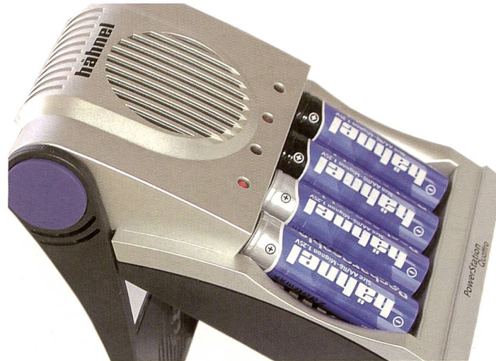
Moderne Ladegeräte verfügen über Einzelschachtsteuerung um die Überladung der Zellen auszuschliessen sowie über eine Refreshing-Funktion. Sie können alle Technologien aufladen, sogar gemeinsam. (Bild: Hähnel)
