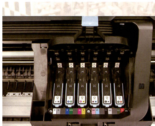
Der HP Z3100 hat 12 Druckfarben. Speziell die 4 Grautöne ermöglichen sehr ausgewogene Schwarzweiss-Drucke.
