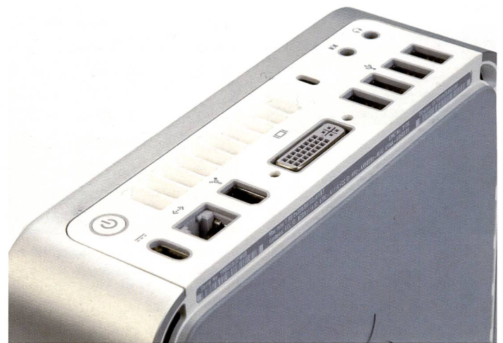
Mac-typische Schnittstellen-Ausstattung (v.l.n.r.): Power, Ethernet, Firewire digitaler Monitorausgang, USB 2.0, Mikrofon, Kopfhörer/ Lautsprecher. S-Video fehlt, DD-Laufwerk ist integriert.
