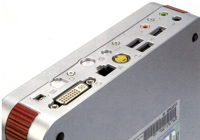
Alle Schnittstellen vorhanden: Firewire (links oben), digitaler Monitor-Ausgang (links unten), Ethernet, S-Video, USB 2.0, Audio. Ein DVD-Laufwerk ist ebenfalls integriert.
