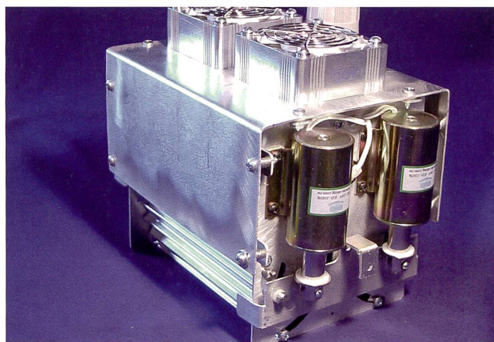
Inkjet-Druckkopf mit integrierter UV-Aushärtung. Während früher vor allem Etiketten monochrom im UV-Inkjet-Druck individualisiert wurden, sind heute Vollfarbanwendungen mit hoher optischer Auflösung möglich.
