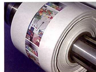
Mit dem UV-Inkjet Druck kann nahezu jedes Material von Papier über Plastik (Bild) bis Glas bedruckt werden.
