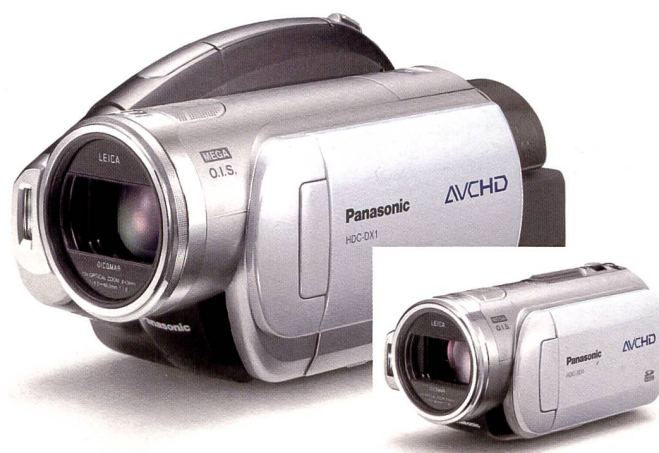
Ganz auf die neuen Speichermedien, sprich 8 cm DVD Scheiben (verschiedene Möglichkeiten) und SD-Karten setzt Panasonic mit den zwei neuen 3-CCD Camcordern im AVCHD-Aufnahmeformat. Beide verfügen über ein 10fach-Leica-Zoomobjektiv und einen optischen Bildstabilisator. Raffiniert ist das ans Zoom gekoppelte Mikrophon.
