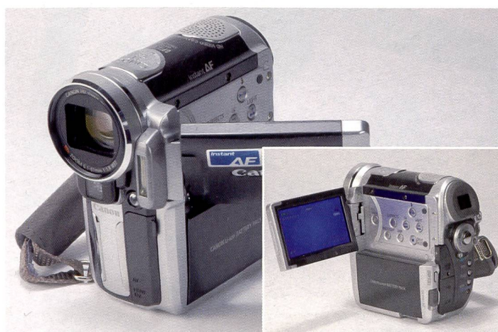
Der zurzeit kleinste HD-Camcorder mit Mini-DV Laufwerk. Die günstigen Speichermedien haben aber den Nachteil, dass nicht direkt auf die einzelnen Szenen zugegriffen werden kann. Eine integrierte LED-Leuchte (leider unter dem Objektiv) hilft bei Party-Szenen die nahestehenden Objekte aufzuhellen.
