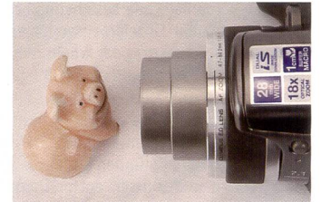
Im Super Makro Modus gelingen mit der Olympus SP-550 UZ Aufnahmen aus einer Distanz von lediglich einem Zentimeter.
