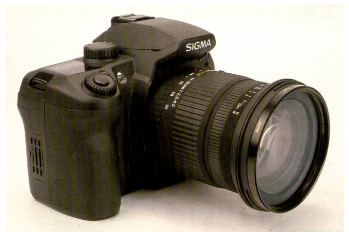
Geht einen anderen Weg: Bei Sigma und der SD14 setzt man auf den X3 CMOS-Sensor mit drei Farbschichten übereinander.
