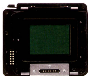
Der Sensor misst 48 x 36 mm und weist 22 Mpixel auf. Die Pixelgrösse sorgt für hohe Bildschärfe.
