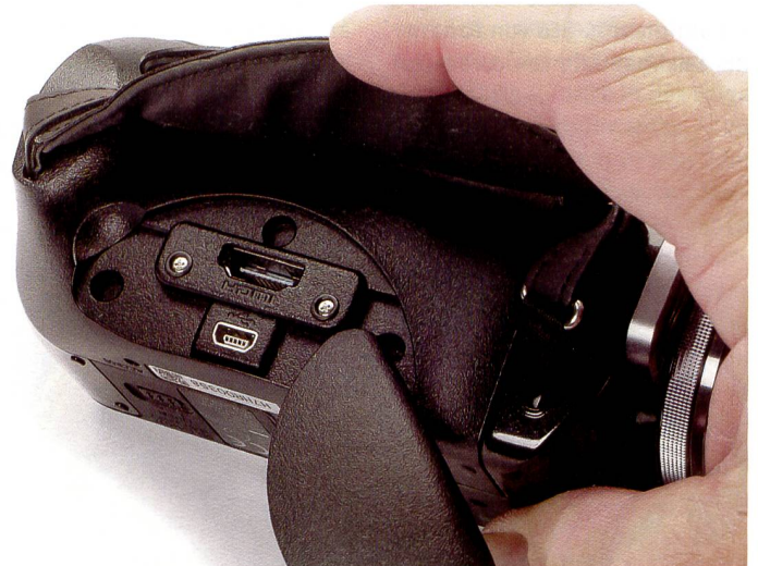
HDMI: die Schnittstelle zum hochauflösenden Bild. Alle Camcorder können sich durch die Verbindung mit einem HDMI-bestückten Fernseher von ihrer besten Seite zeigen.
