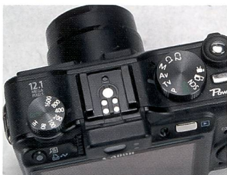
Die Canon G9 hat gleich zwei Wählräder: Für die Wahl der Sensorempfindlichkeit und des Modus.
