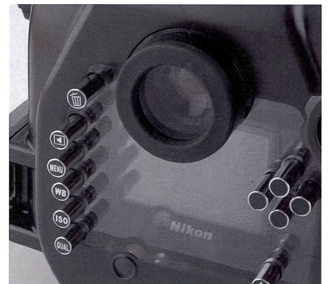
Mit den Stiften auf der Rückseite des Gehäuses werden die Drucktasten der Kamera bedient. Der Monitor ist auch unter Wasser gut sichtbar.
