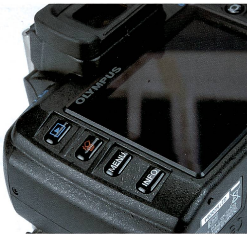
Die Rückseite der Olympus E-420 wird dominiert von einem grosszügigen 2,7-Zoll-Monitor mit 230'000 Bildpunkten. Im Liveview lassen sich Details sieben- oder zehnfach vergrössert anzeigen. Die Kamera ist trotz ihrer Kompaktheit erfreulich griffig.
