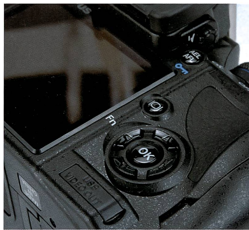
Die Rückseite der Olympus E-420 wird dominiert von einem grosszügigen 2,7-Zoll-Monitor mit 230'000 Bildpunkten. Im Liveview lassen sich Details sieben- oder zehnfach vergrössert anzeigen. Die Kamera ist trotz ihrer Kompaktheit erfreulich griffig.
