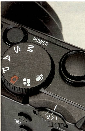
Die Sigma DP1 erlaubt dem Nutzer viele manuelle Eingriffe. Eine Besonderheit ist das Fokussierrädchen für den Daumen.
