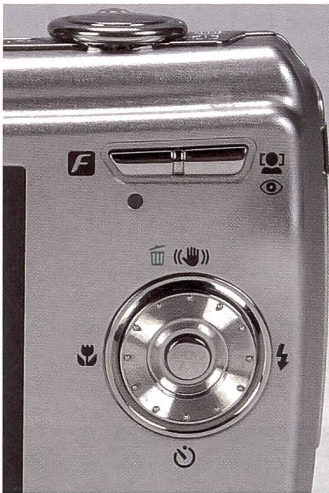
Mit dem Knopf oben rechts wird bei Fujifilm Finepix F100fd die Gesichtserkennung zugeschaltet.
