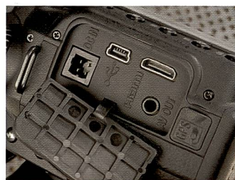
Nikon bietet u.a. Anschlüsse für externe Stromquellen und HDMI-Ausgang für TV/Video.
