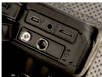
Canon unterstreicht den Profianspruch der EOS 50D mit der Blitzsynchronbuchse.
